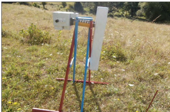
Slika 2. Fluxgate FM256 magnetometar (foto Vejzagić)
